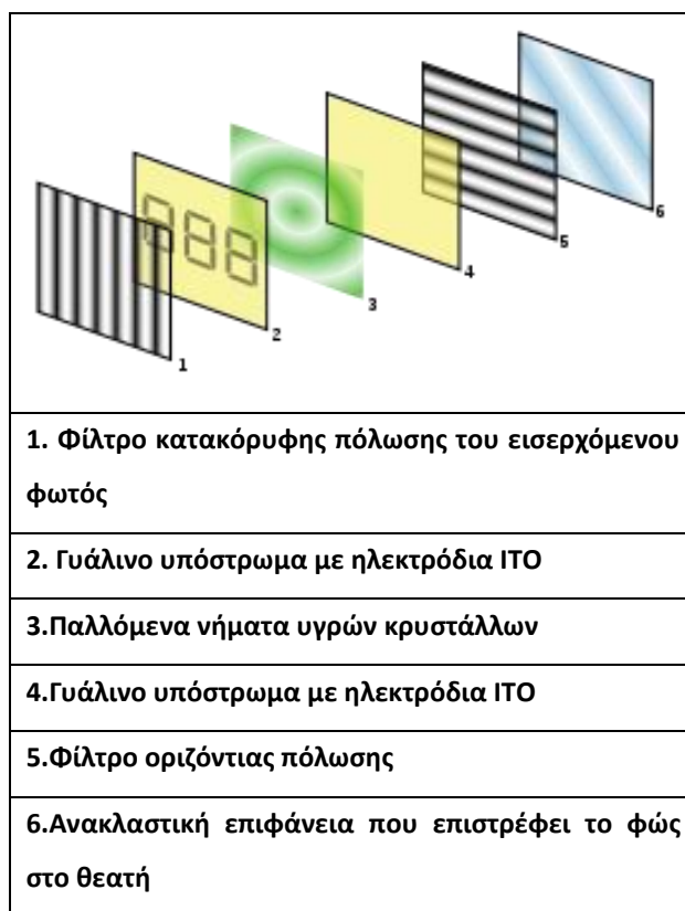
Εικόνα 5: Τα στρώματα οθόνης LCD ( Wikipedia, 2014 )
