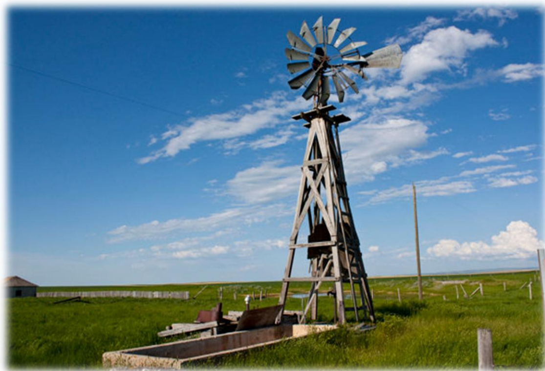
Εικόνα 14. Εφαρμογή της τεχνολογίας αιολικής άντλησης σε φάρμα. ( www.windpoweronwildsteerbutte.com , 2011)
