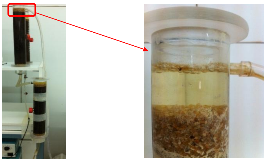
Σχήμα 8.14α: Πειραματική διάταξη με δύο εργαστηριακές στήλες σε σειρά
