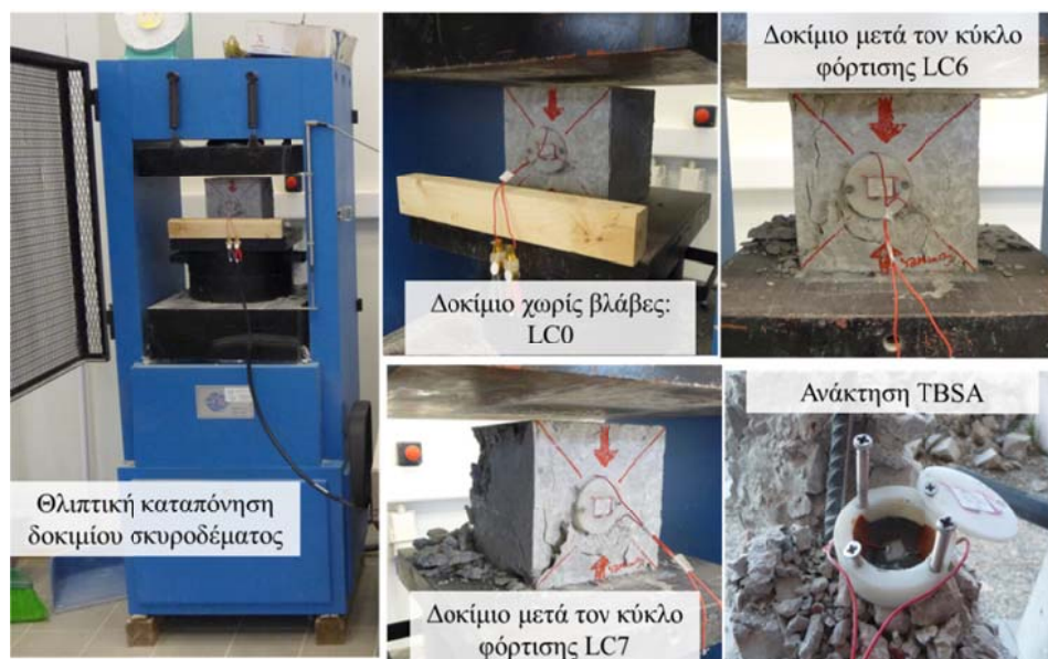
Σχήμα 5.24: Σταδιακή θλιπτική καταπόνηση δοκιμίου σκυροδέματος με εμφυτευμένο TBSA.
