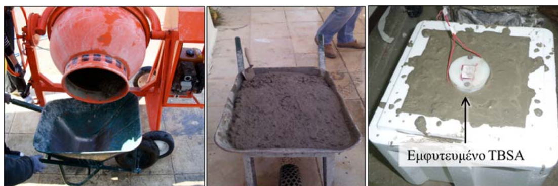
Σχήμα 5.1: Παρασκευή δοκιμίων σκυροδέματος.
