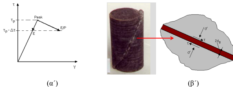
Σχήμα 1.18: (α) Χαλάρωση της τάσης σε τριαξονική δοκιμή, και (β) σχηματισμός ζώνης διάτμησης με τη μορφή διατμητικής ασυνέχειας σε κυλινδρικό δοκίμιο πετρώματος.
