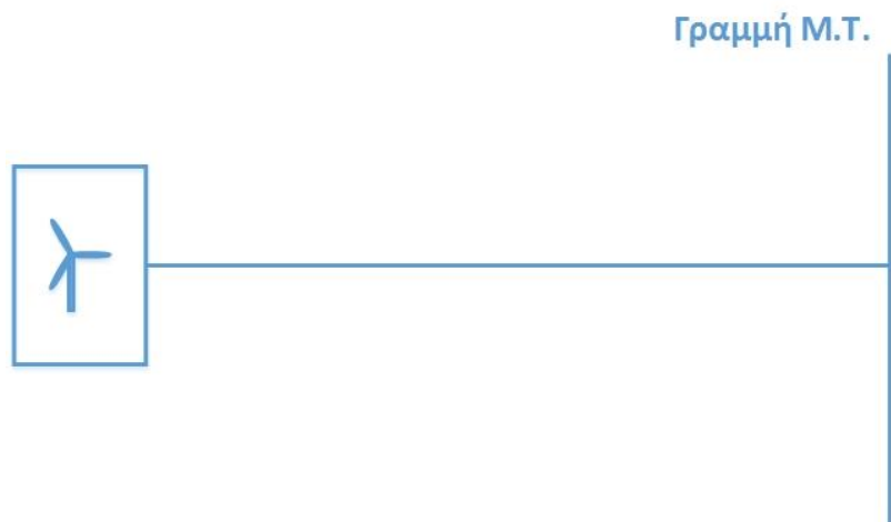
Σχήμα 2-1: Απευθείας σύνδεση στο πλησιέστερο σημείο του δικτύου Μ.Τ μέσω γραμμής Μ.Τ.
