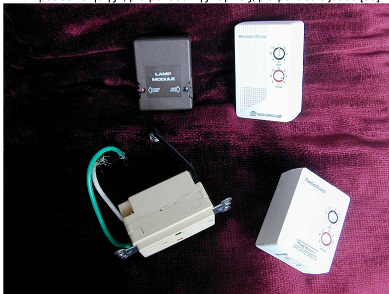
Σχήμα 5.6. X10 modules (δεξιόστροφα από επάνω αριστερά): Μια πρωτότυπη μονάδα λυχνίας BSR, μια «μονάδα ηχητικής προειδοποίησης», μια μονάδα της λάμπας, μια μονάδα εξόδου [39]
