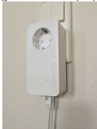
Σχήμα 5.5 Σύγχρονος Power-line adaptor μάρκας devolo με επιπλέον υποδοχή ρεύματος ταχύτητα μεταφοράς μέχρι 600 Mbit/s - συνδεδεμένο με καλώδιο LAN [45].
