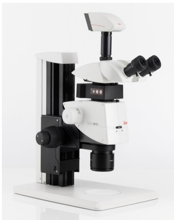
Σχήμα 4.1 : Το στερεομικροσκόπιο Leica M125
