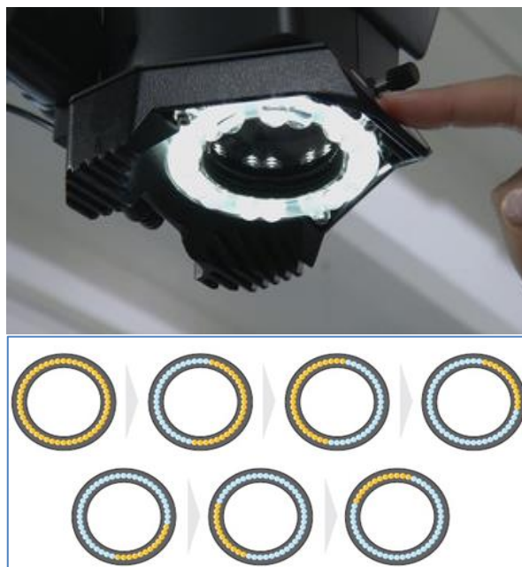
Σχήμα 4.4: Δακτύλιος φωτισμού του στερεοσκοπίου Leica M125
