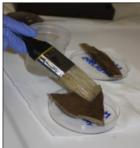
Εικόνα 3.7: Εφαρμογή διαλύματος με πινέλο σε αμιαντοτσιμέντο
