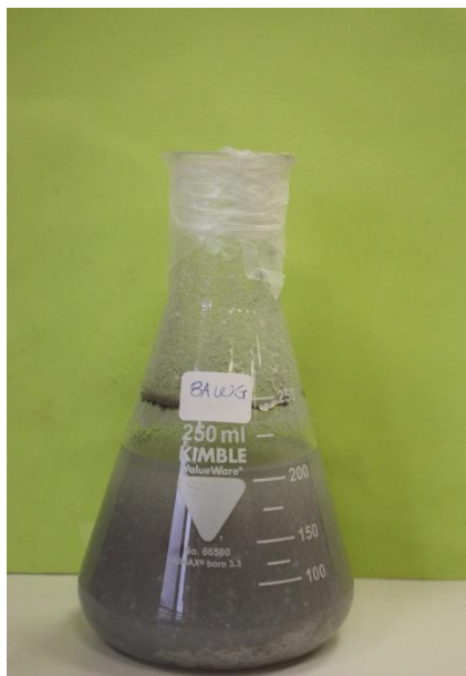
Εικόνα 3.4: Διάλυμα χρυσοσιλικικού αμιάντου με καθαρή υδρύαλο
