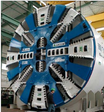
Σχήμα 4.3: EPB (Αττικό Μετρό, 2006)
