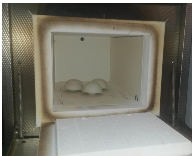
Εικόνα 12: Κεραμικά σκεύη με απόβλητο καφέ μέσα σε κλίβανο πυρόλυσης- προετοιμασία biochar
