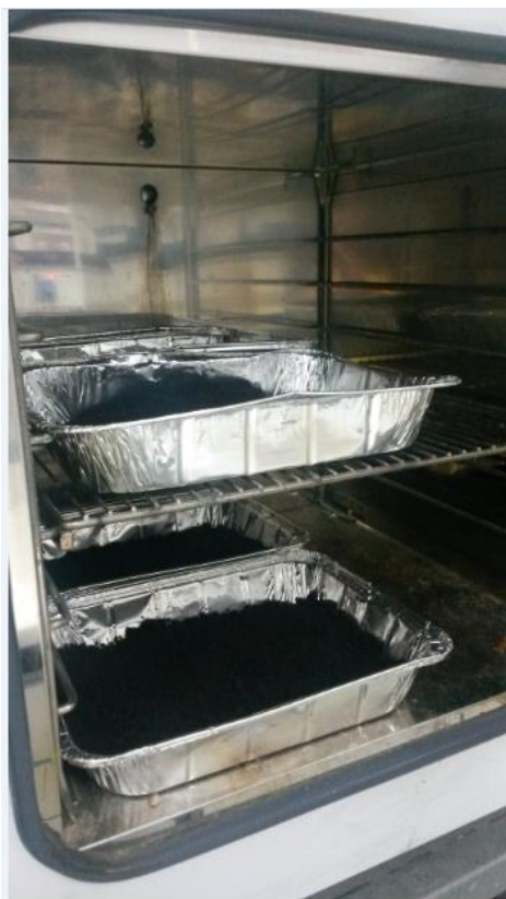
Εικόνα 11: Ξήρανση αποβλήτου καφέ στους 100° C
