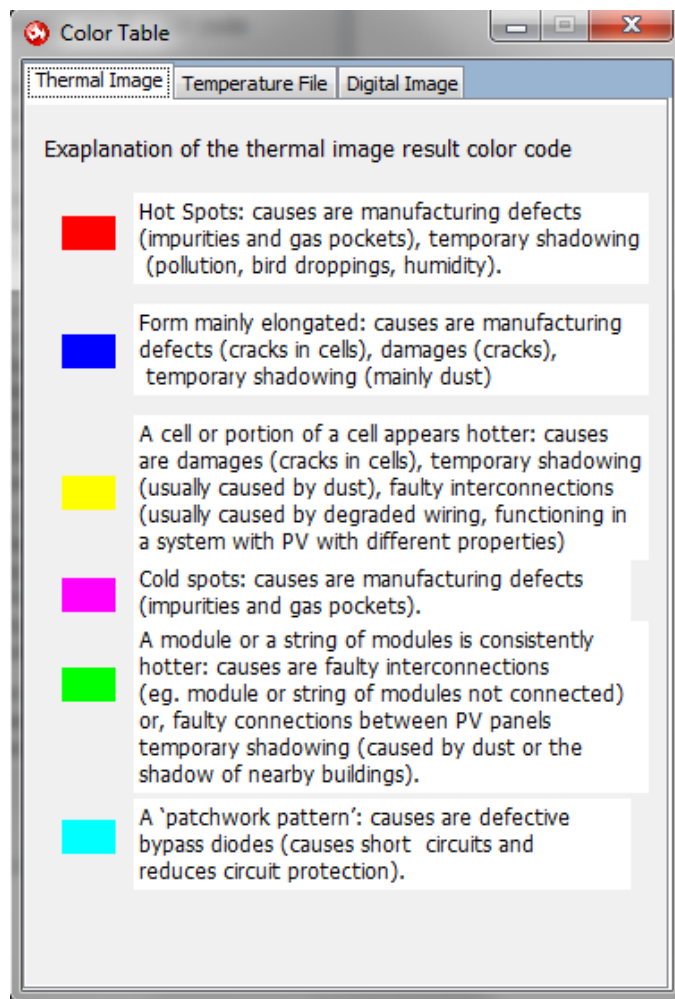
Εικόνα 4-17: Pop-up παράθυρο της εφαρμογής που επεξηγεί τον χρωματικό κώδικα βλαβών ο οποίος χρησιμοποιείται.
