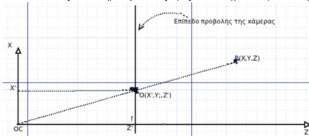
Σχήμα 2.14: Η οπτική του συστήματος(οπτικό κέντρο κάμερας – επίπεδο προβολής της κάμερας – σημείο που εντοπίζεται) στο σύστημα αξόνων x-z
