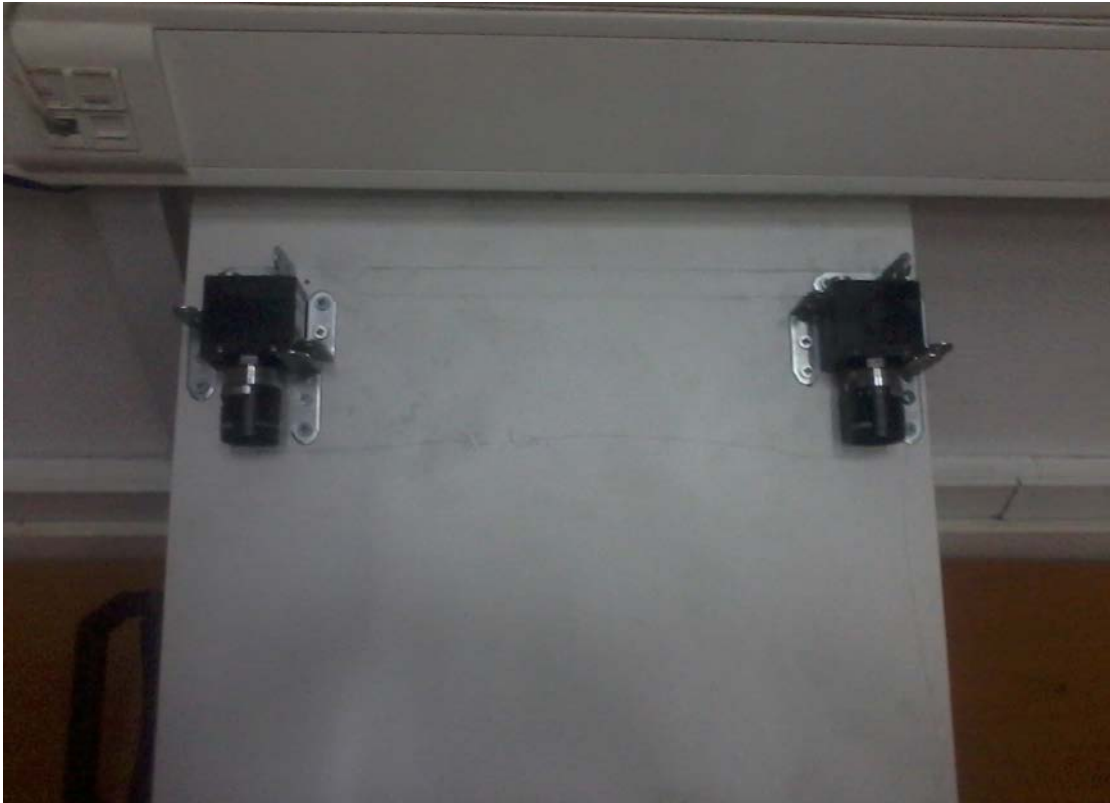
Εικόνα 2.6: Η διάταξη ενός σκετ καμερών με τις θήκες για την σταθεροποίηση των καμερών. Η εν λόγω διάταξη κατασκευάσθηκε στο εργαστήριο m3.
