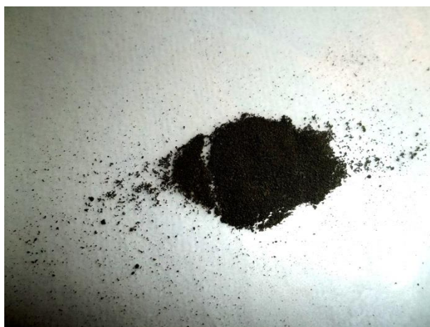
Εικόνα Γ.3.1: Τελικό προϊόν σιδήρου που παρασκευάστηκε με αναγωγή και αντίδραση με θειακεταμίδιο.
