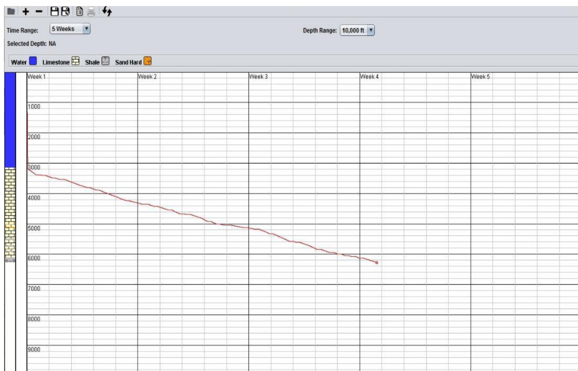
Διάγραμμα 7.9: Χρόνος γεώτρησης με σχέση τον βάθος
