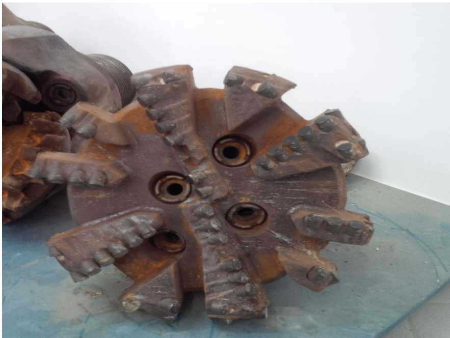
Εικόνα 2.2: Τοποθέτηση ακροφυσίων στο κοπτικό άκρο (Κοπτικό άκρο, Πολυτεχνείο Κρήτης, 2014)
