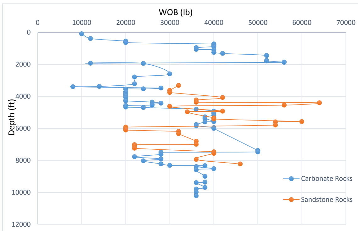
Διάγραμμα 10.6: Οι διακυμάνσεις του WOB των ανθρακικών και ψαμμιτικών πετρωμάτων με το βάθος
