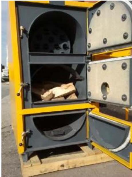
Εικόνα: Λέβητας με ανοιχτές τις τρεις πόρτες. Διακρίνεται η μόνωση από βερμικουλίτη στις δυο πάνω πόρτες
