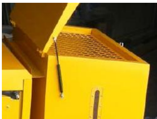
Εικόνα: Στεγανό καπάκι του σιλό το οποίο ανοίγει με αμορτισέρ για μεγαλύτερη ευκολία και θυρίδα επιθεώρησης ποσότητας καυσίμου
