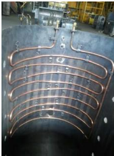
Εικόνα: Σερπατίνα εναλλαγής θερμότητας με χάλκινη σωλήνα
