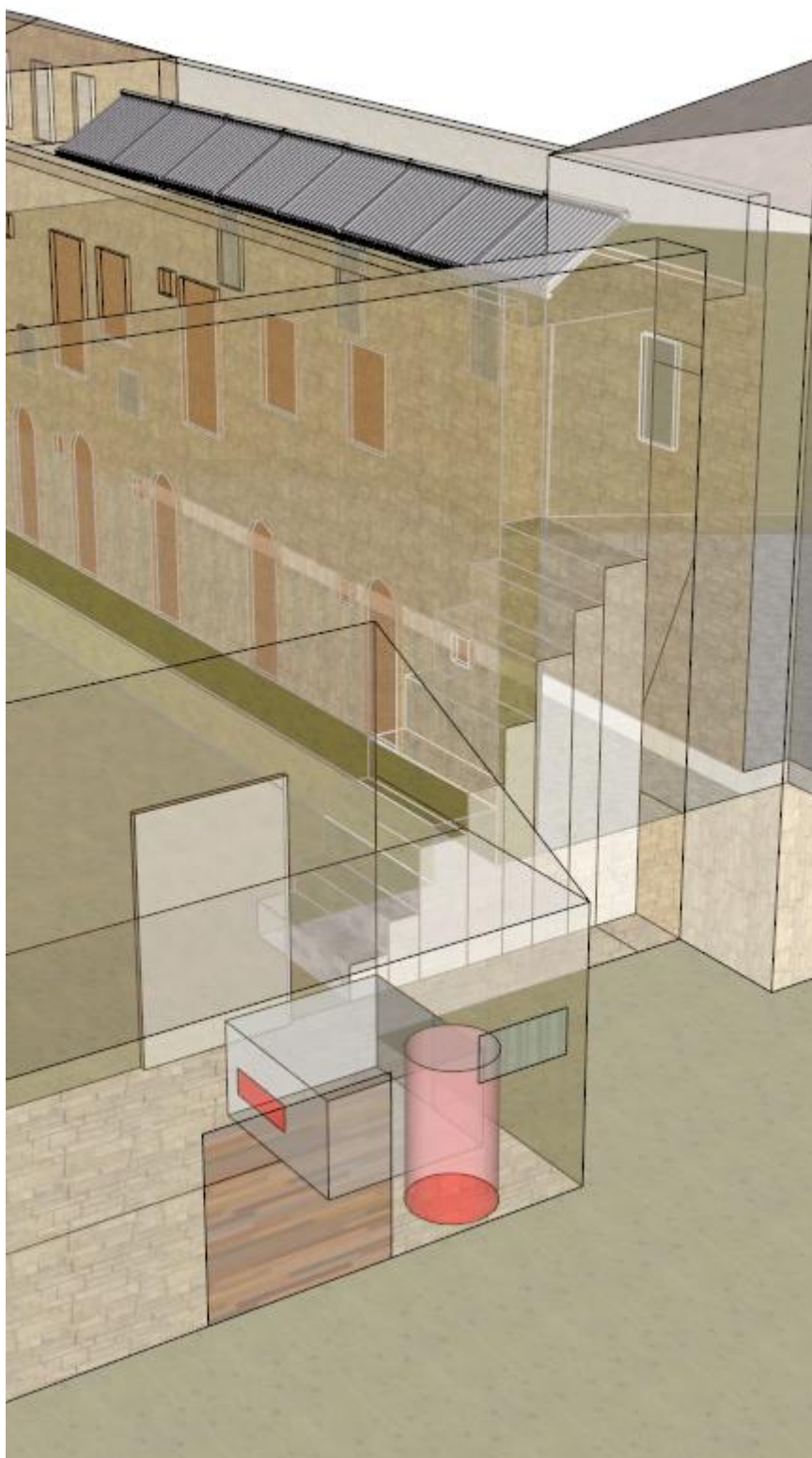
Εικόνα 12: Θέση δοχείου αδρανείας στο λεβητοστάσιο
