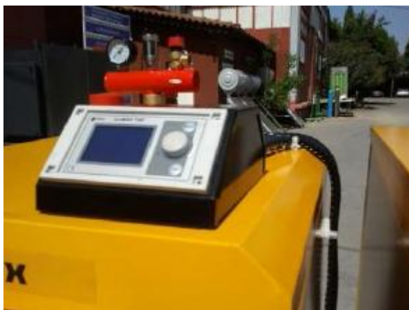
Εικόνα: Πίνακας EcoMax για ακριβή έλεγχο της τροφοδοσίας του καυσίμου, έλεγχος της ισχύος του ανεμιστήρα, συντήρηση φλόγας, αυτόματη έναυση
