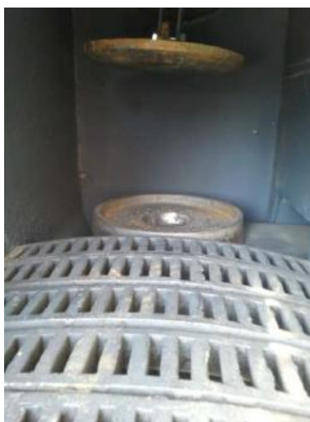
Εικόνα: Εσωτερικό του θαλάμου καύσης με την εστία καύσης, τις σχάρες για τα ξύλα και τον μαντεμένιο καταλύτη, ο οποίος πυρολύει τα καυσαέρια
