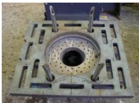
Εικόνα: Εστία καύσης με ακροφύσια δευτερεύοντος αέρα, ειδική για καύσιμα που παράγουν πτητικά αέρια όπως ο ελαιοπυρήνας
