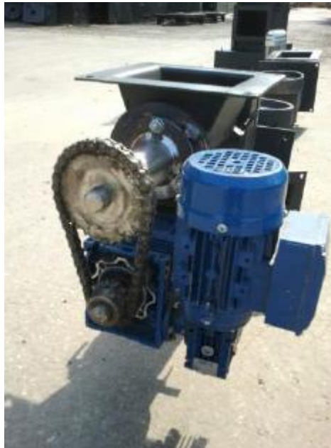
Εικόνα: Σύστημα μετάδοσης κίνησης διβάθμιου τροφοδότη
