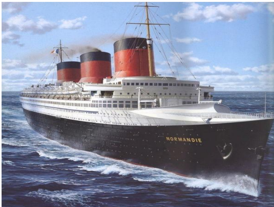
Εικόνα 1.2 Το πλοίο S/S Normandie χρησιμοποιούσε ένα σύστημα ηλεκτροπρόωσης, ήταν το πρώτο σκάφος που διέσχισε τον ατλαντικό κινούμενο με 30 και πλέον κόμβους. (πηγή en.wikipedia.com)
