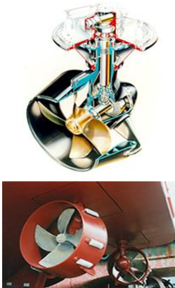
Εικόνα 1.9 Αξιμουθιακός προωστήρας [8]
