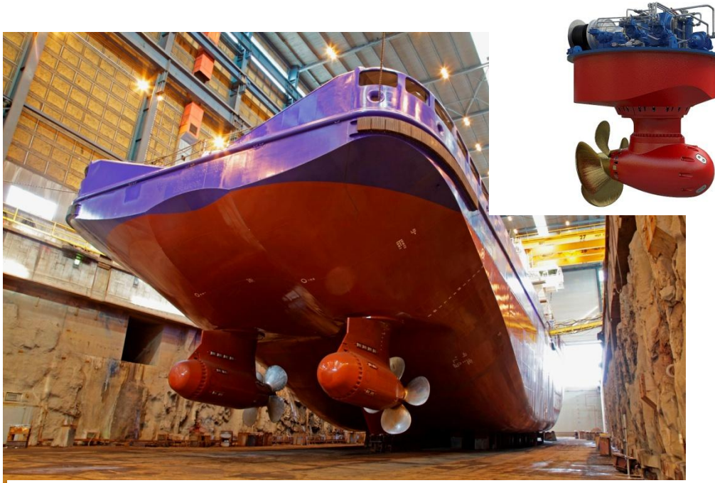
Εικόνα 1. 1 Προωστήρας azimuth του παγοθραυστικού "Vitus Bering" [10]
