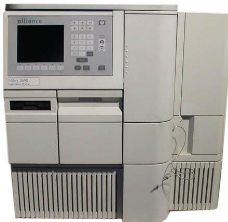
Εικόνα 2-4 : Υγρός χρωματογράφος τύπου Waters Alliance 2690
