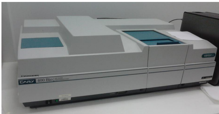
Εικόνα 2-5 : Φασματοφωτόμετρο Varian Cary 400 UV/Vis
