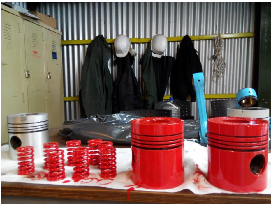
Σχήμα 4.10 : Ελατήρια βαλβίδων και έμβολα.
