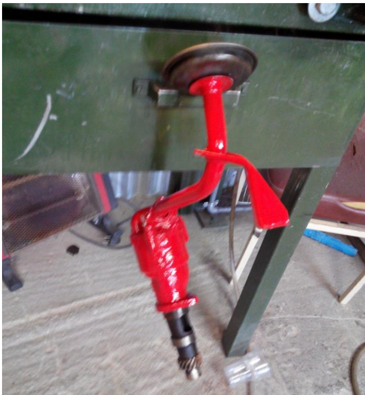
Εικόνα 4.11 : Αντλία λαδιού λίπανσης της μηχανής.
