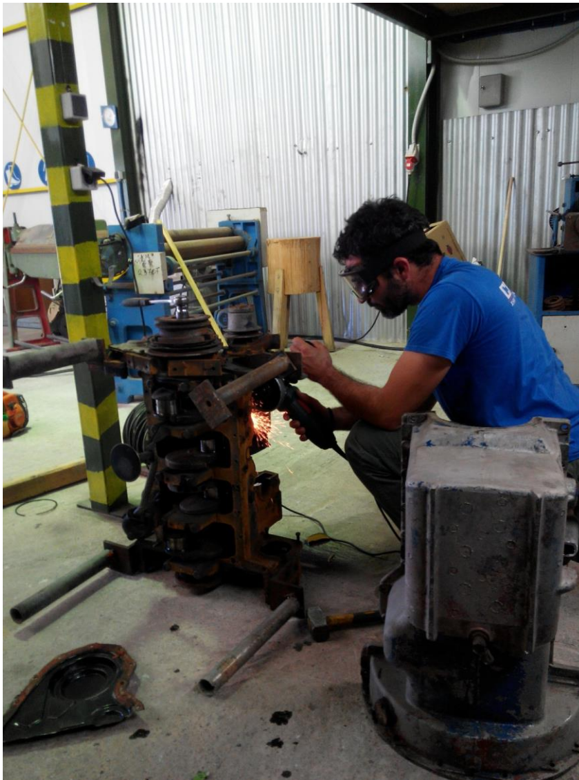
Σχήμα 4.4 : Τομές στο σώμα των κυλίνδρων
