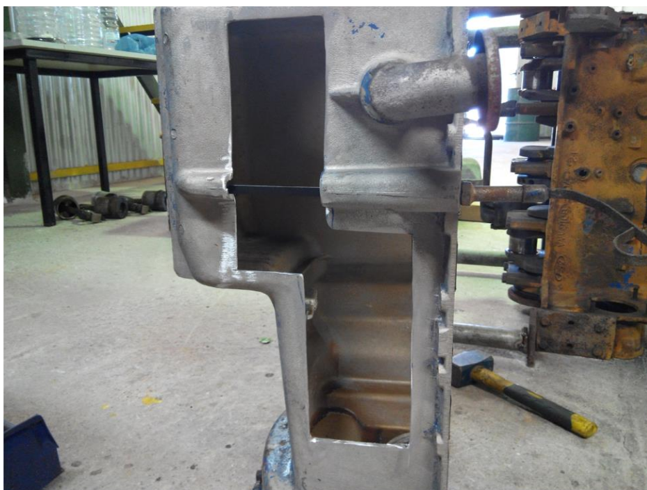
Σχήμα 4.3 : Το Κάρτερ μετά τις τομές
