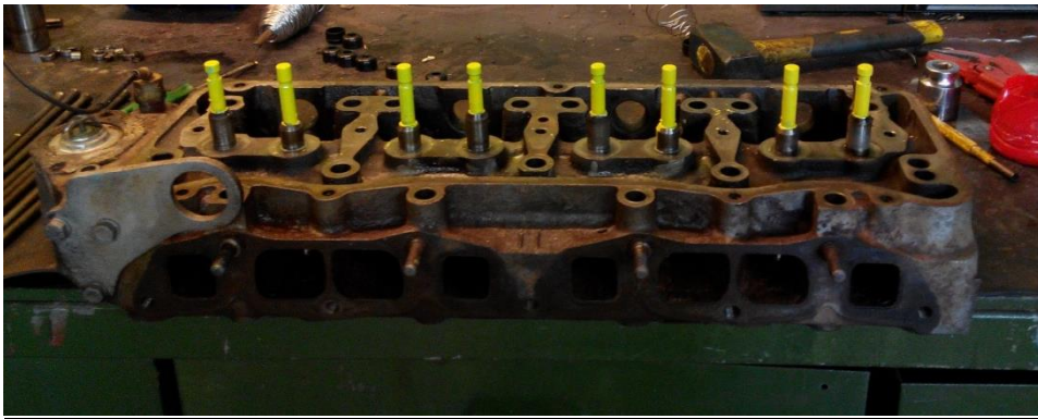
Σχήμα 4.5 : Με κίτρινο διακρίνονται οι βαλβίδες κατά την συναρμολόγησή τους
