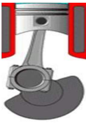
Σχήμα 3.2 : Χιτώνια μέσα στα οποία παλινδρομεί το έμβολο
