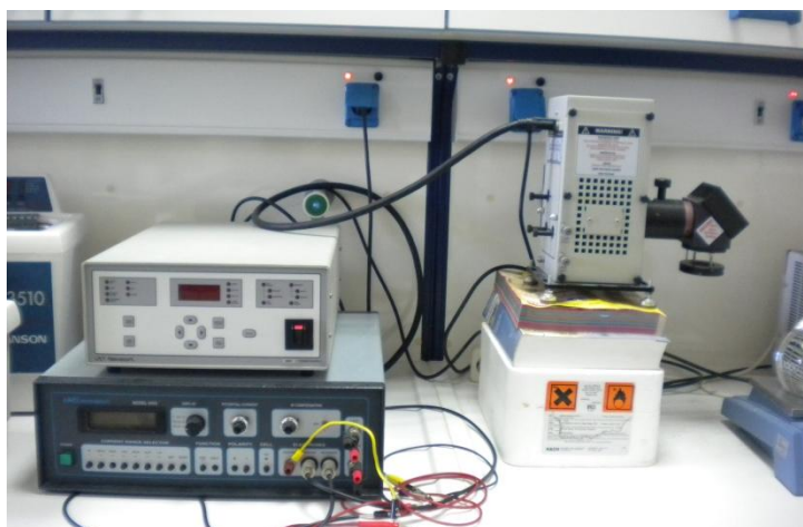
Εικόνα 3.1 Προσομοιωτής ηλιακής ακτινοβολίας
