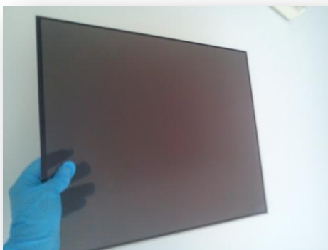
Εικόνα 14: Τελική μορφή του πάνελ μετά την αφαίρεση της κόλλας
