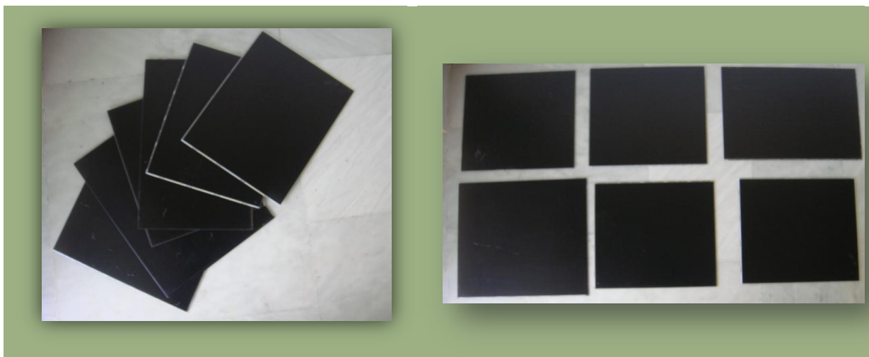
Εικόνα 8: Οθόνες ΑΗΗΕ μετά την αποσυναρμολόγηση
