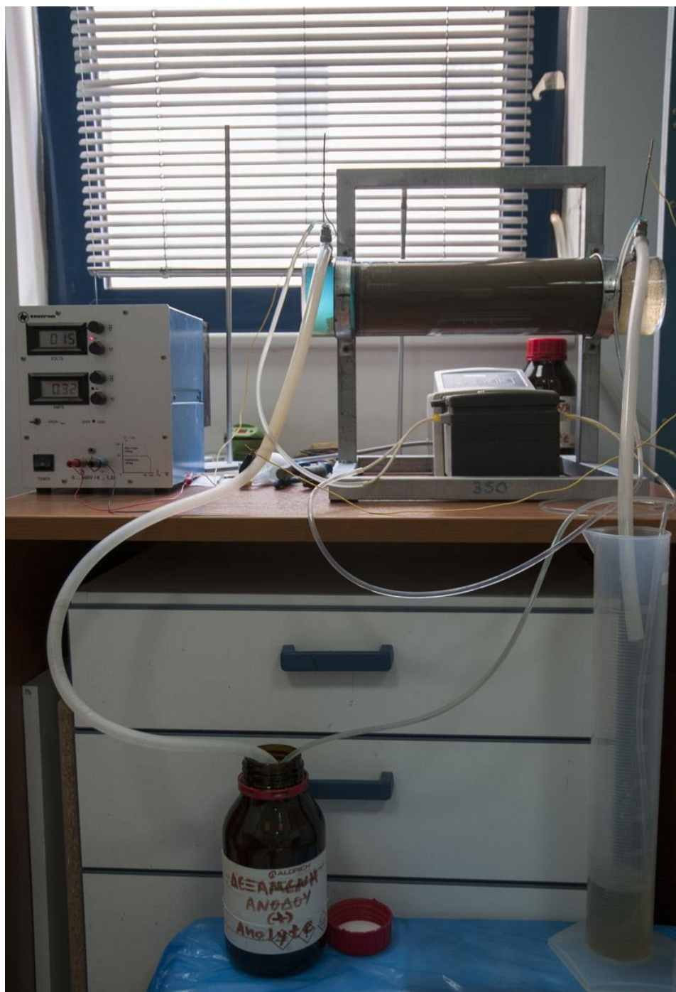
Φωτογραφία 3.3 Απεικόνιση κλειστού κυλινδρικού συστήματος ηλεκτροκινητικής.
