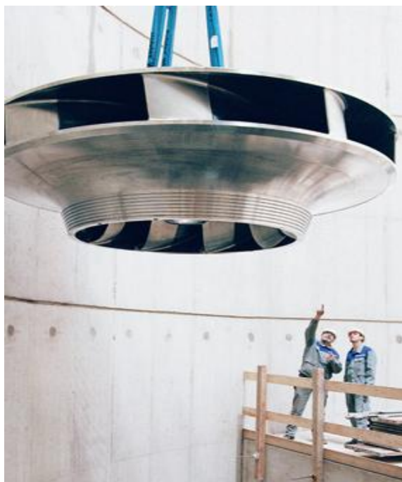
Εικ. 3.6 Αντλιοστρόβιλος τύπου Francis. Κατασκευαστής Voith Siemens. Στο κάτω μέρος διακρίνεται η διάταξη του στροβίλου ενώ στην περιφέρεια παρατηρούμε τα περύγια της αντλίας (Voith)
