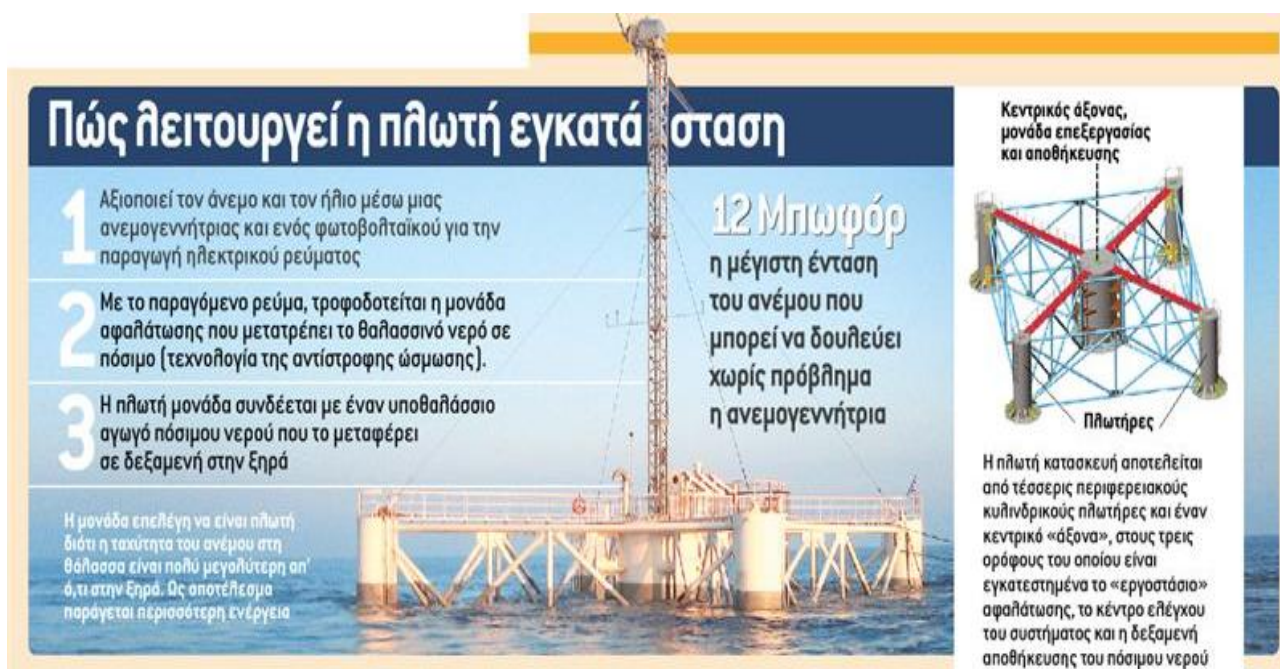
Εικ. 3.11 Απεικόνιση της αυτόνομης πλωτής μονάδας αφαλάτωσης του Πανεπιστημίου Αιγαίου
