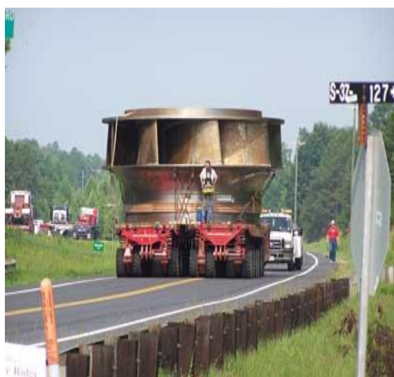
Εικ. 3.7 Αντλιοστρόβιλος 150 τόνων μεταφέρεται στην τοποθεσία Jocassee. (Pow)
