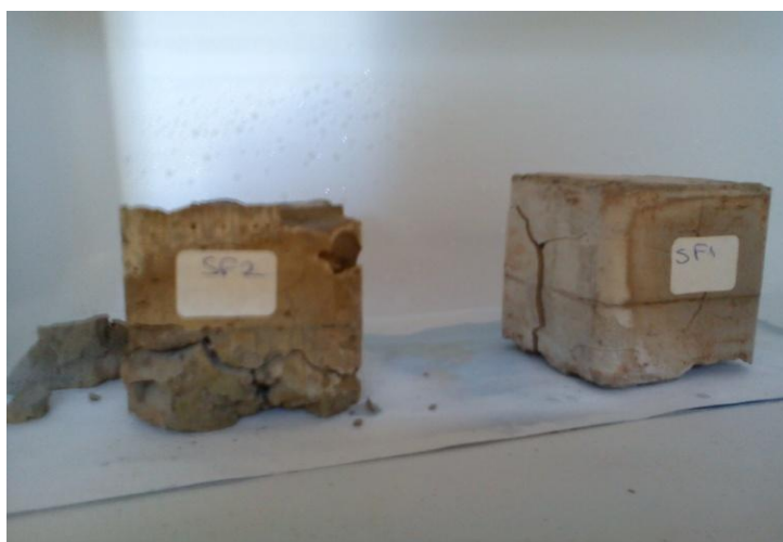
Σχήμα 4.10: δοκίμια μετά απ τον πρώτο μήνα δοκιμών κύκλων ψύξης θέρμανσης
