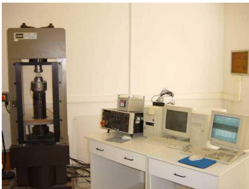
Σχήμα 4.3: Μηχανή MTS 1600 σύστημα υπολογιστών
