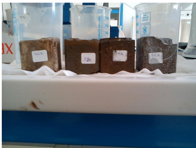
Σχήμα: 4.9: Γεωπολυμερή μετά από εμφάνιση σε διάφορα διαλύματα
