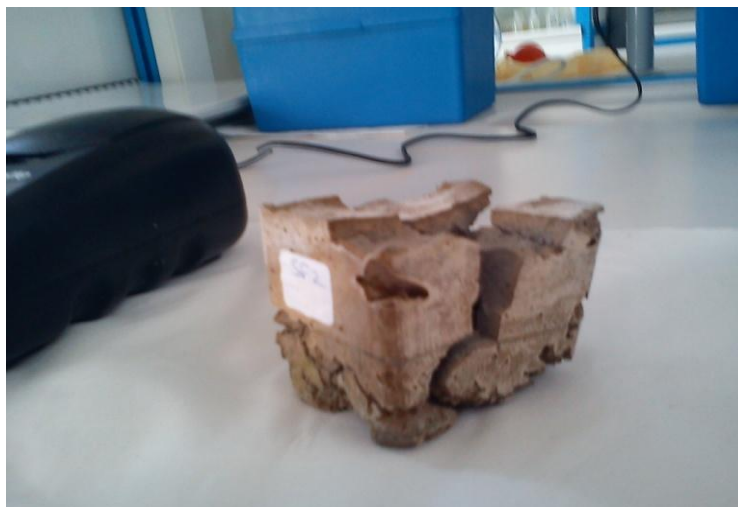
Σχήμα 4.11: Δοκίμιο μετά των πρώτο μήνα δοκιμών κύκλων ψύξης θέρμανσης
