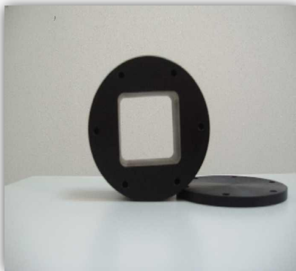
Σχήμα 4.1: Μήτρα χύτευσης
