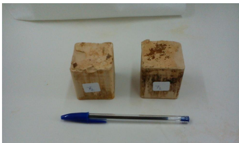
Σχήμα 4.6: Γεωπολυμερή τα οποία θερμάνθηκαν στους 700 °C
