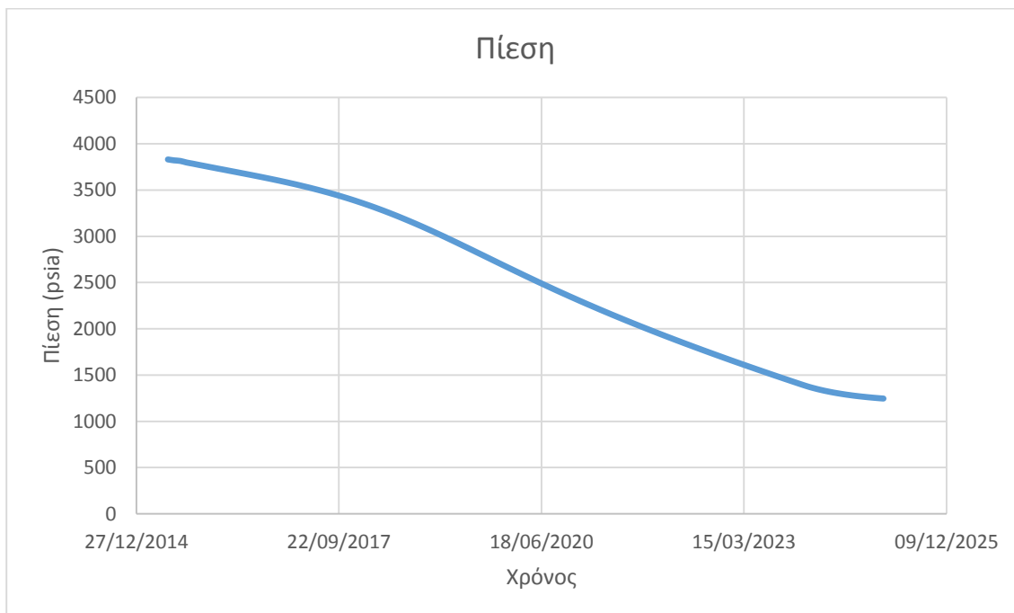
Διάγραμμα 4.1: Πρόβλεψη παραγωγής σεναρίου P50 - Προφίλ της πίεσης ως προς τον χρόνο για τον ταμιευτήρα Χ
