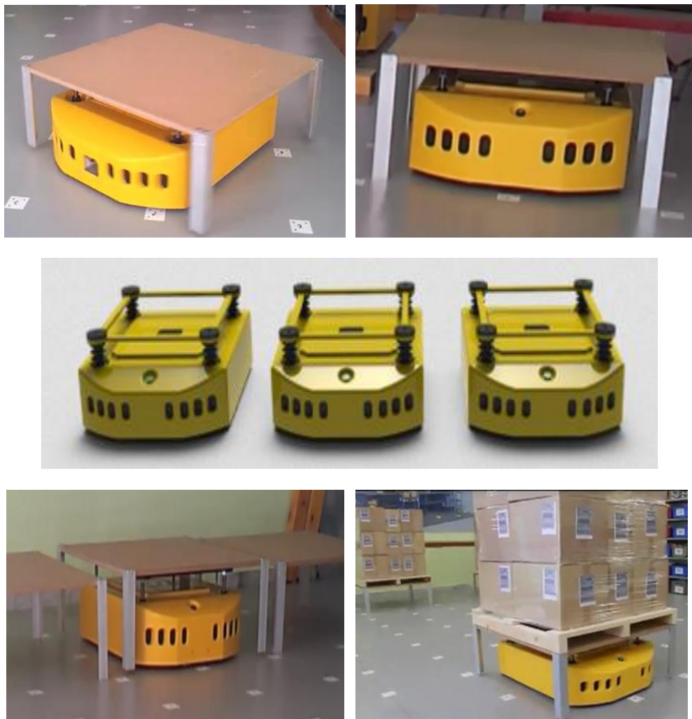
Εικόνα 2.9: Τα ρομποτικά οχήματα αποτελούν τον κορμό του συστήματος διαχείρισης υλικών του κέντρου διανομής ( www.interlink.gr . © INTERLINK AUTOMATIONS S.A. Παραχωρήθηκε άδεια χρήσης.).
