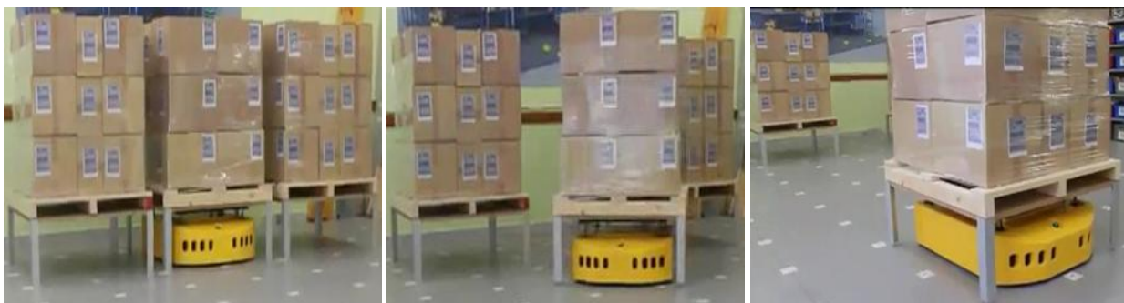
Εικόνα 2.15: Απεικόνιση διαδικασίας λήψης και μεταφοράς βάσης παλέτας (τράπεζας) από το ρομποτικό όχημα.
