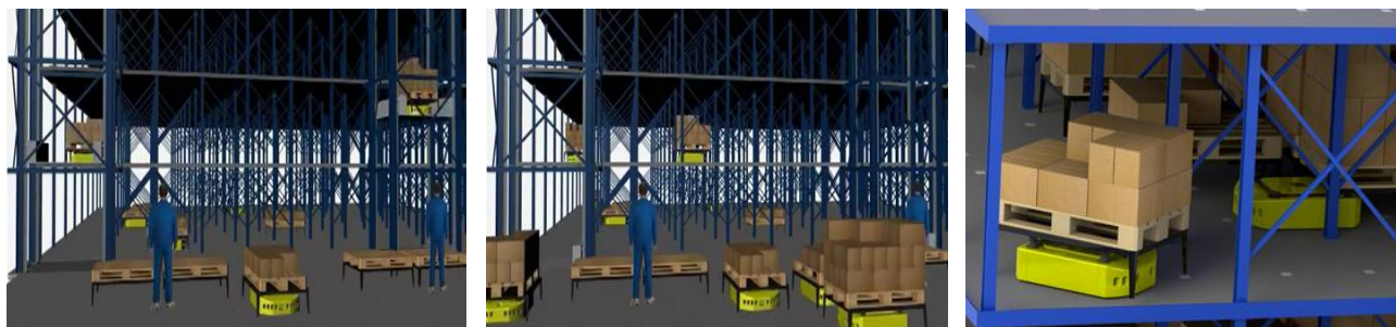
Εικόνα 2.20: Ρομποτικά οχήματα μεταφέροντας παλέτες μοναδιαίου φορτίου από την κυρίως αποθήκη προς τροφοδοσία των σταθμών διαλογής με τους ζητούμενους κωδικούς κάθε φορά.
