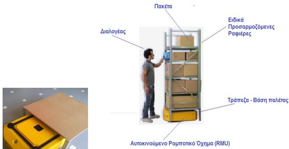
Εικόνα 2.22: Ο διαλογέας και το ρομποτικό όχημα με την τράπεζα, τη ραφιέρα και τα κιβώτια που αυτή φέρει.
