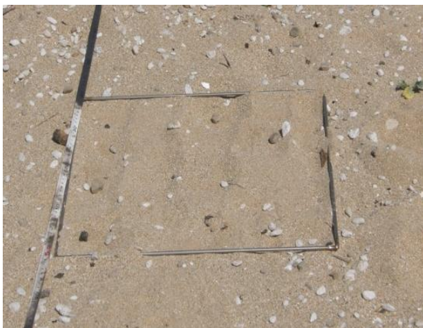
Εικόνα 11. Το μέγεθος της δειγματοληπτικής μονάδας για τη συλλογή πλαστικών από την επιφάνεια του υποστρώματος οριζόταν από μεταλλικά πλαίσια, ενώ η θέση τους προσδιοριζόταν με μετροταινίες που αναπτυσσόταν στα σημεία των διατομών
