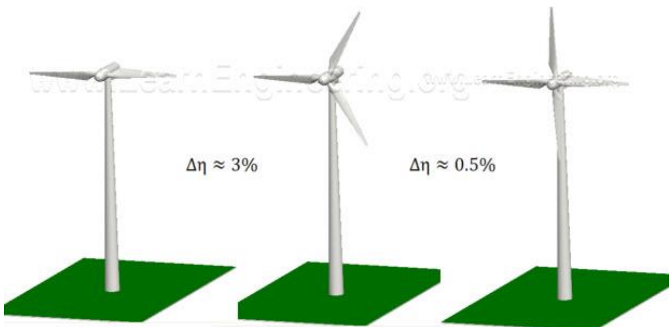
Σχήμα 1.4: Μεταβολή αεροδυναμικής απόδοσης με την αύξηση του αριθμού πτερυγίων [7].
