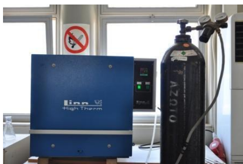
Εικόνα 4.2: Η διάταξη του φούρνου πυρόλυσης στο εργαστήριο με αέριο N_2
