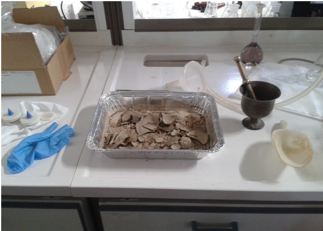
Εικόνα4.3 Το δείγμα όπως αφαιρείται από το φούρνο ξήρανσης και πριν ομογενοποιηθεί με το γουδί και τοποθετηθεί στη στήλη.
