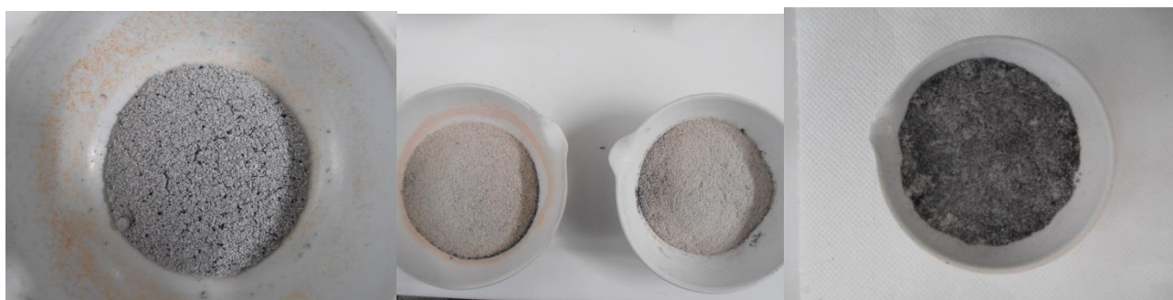
Εικόνα 11: (Από αριστερά προς τα δεξιά) βιοεξανθράκωμα 500°C στέμφυλα , βιοεξανθράκωματα 500°C φλοιών ρυζιού , βιοεξανθράκωμα 500°C κλαδέματα ελιάς
