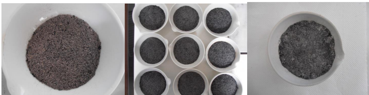
Εικόνα 10: (Από αριστερά προς τα δεξιά) βιοεξανθράκωμα 300°C στέμφυλα , βιοεξανθράκωματα 300°C φλοιών ρυζιού , βιοεξανθράκωματα 300°C βαθμών κλαδεμάτων ελιάς
