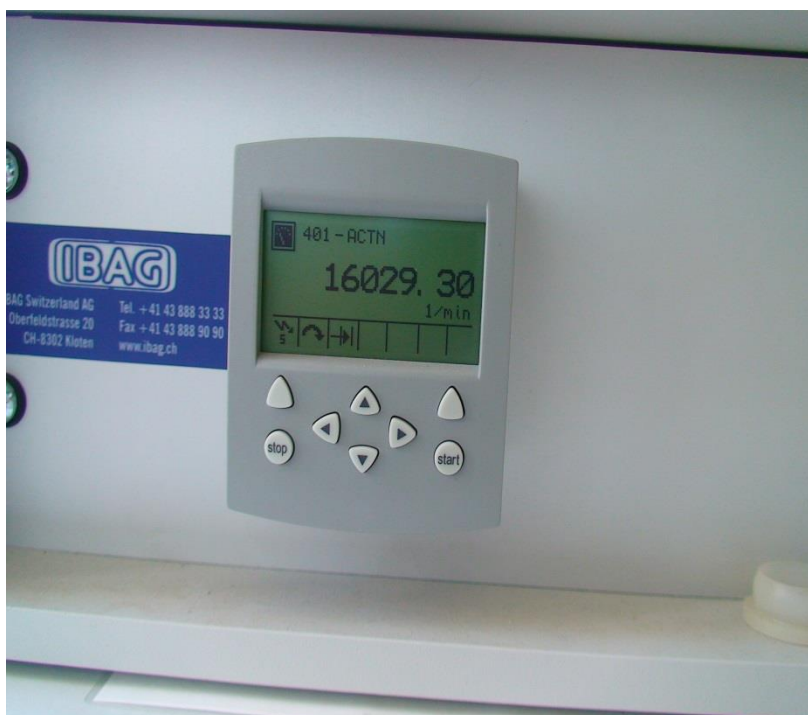
Σχήμα 4.6: Στροφές για κοπτικό εργαλείο διαμέτρου D=1\text{ mm}
