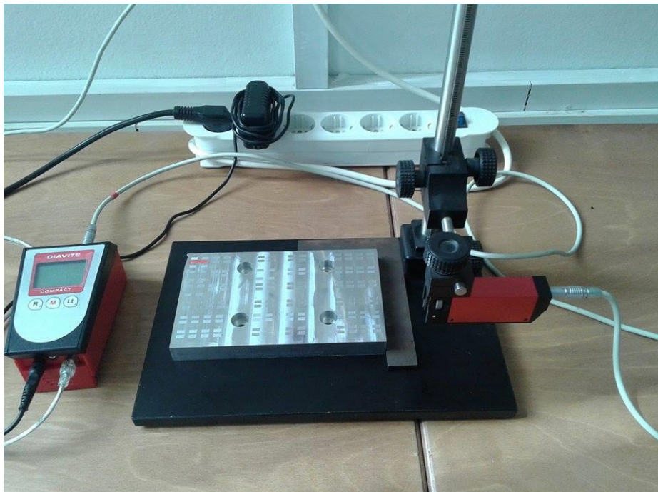
Σχήμα 3.5: Τραχύμετρο Diavite compact
