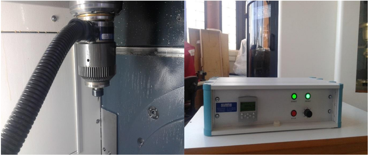
Σχήμα 3.9: Περιστροφικό υψηλόστροφο τσοκ
