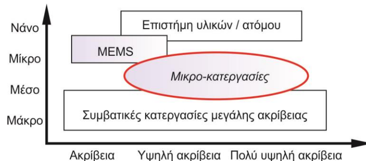
Σχήμα 2.1: Διαστάσεις κατεργασιών μικροκλίμακας
