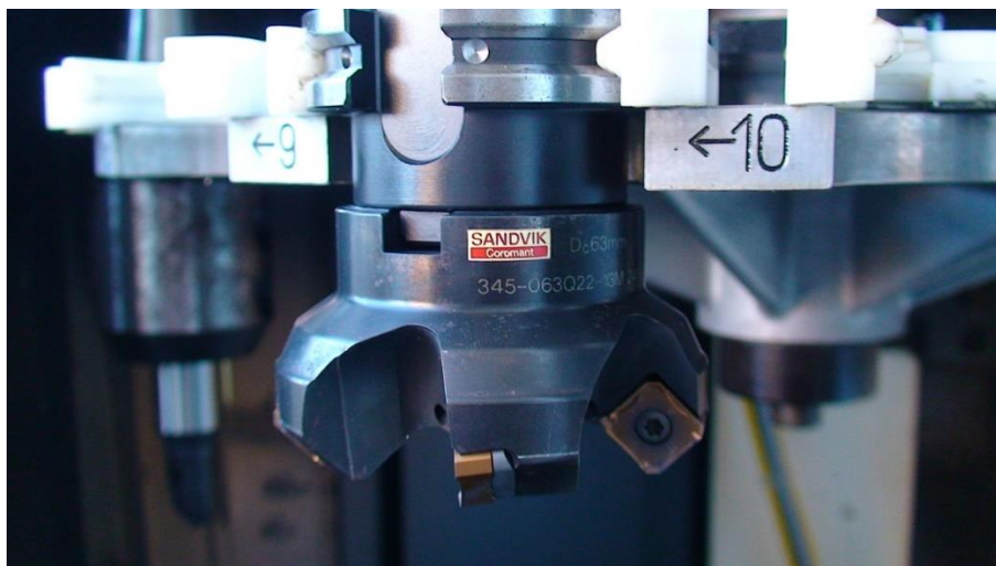
Σχήμα 3.7: Κοπτικό εργαλείο εκχόνδρισης
