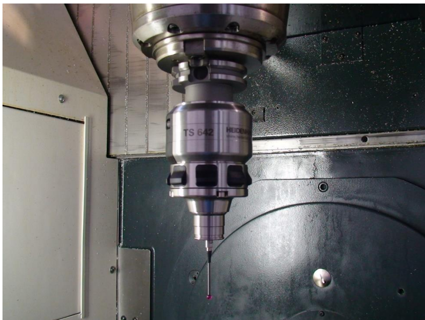
Σχήμα 3.6: Τρισδιάστατος ανιχνευτής ακμών
