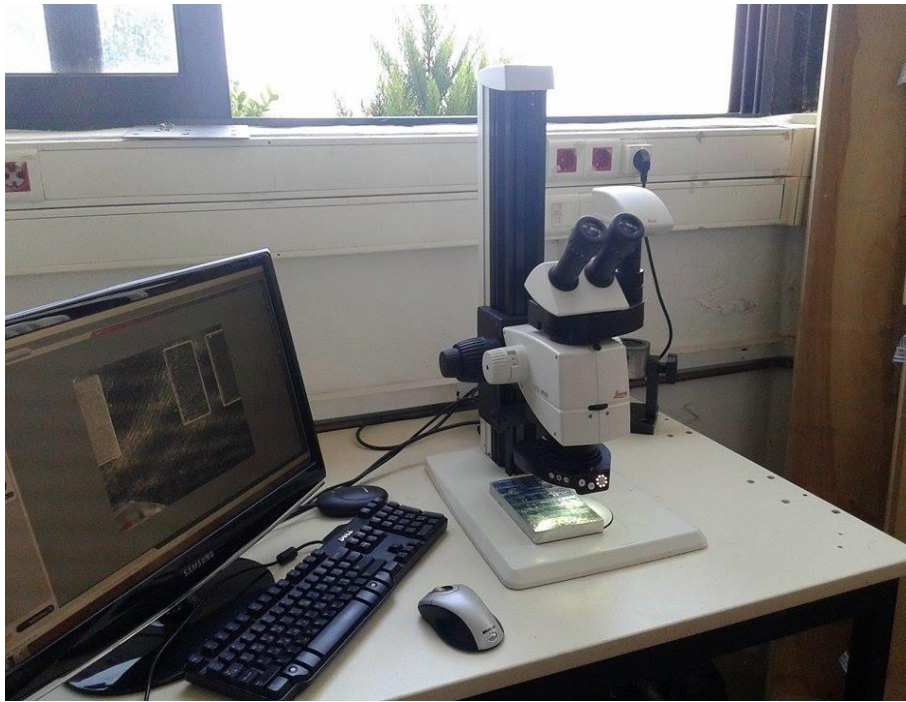
Σχήμα 3.4: Στερεοσκόπιο Leica M125
