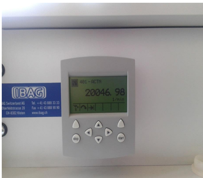
Σχήμα 4.7: Στροφές για κοπτικό εργαλείο διαμέτρου D=0,8\text{ mm}
