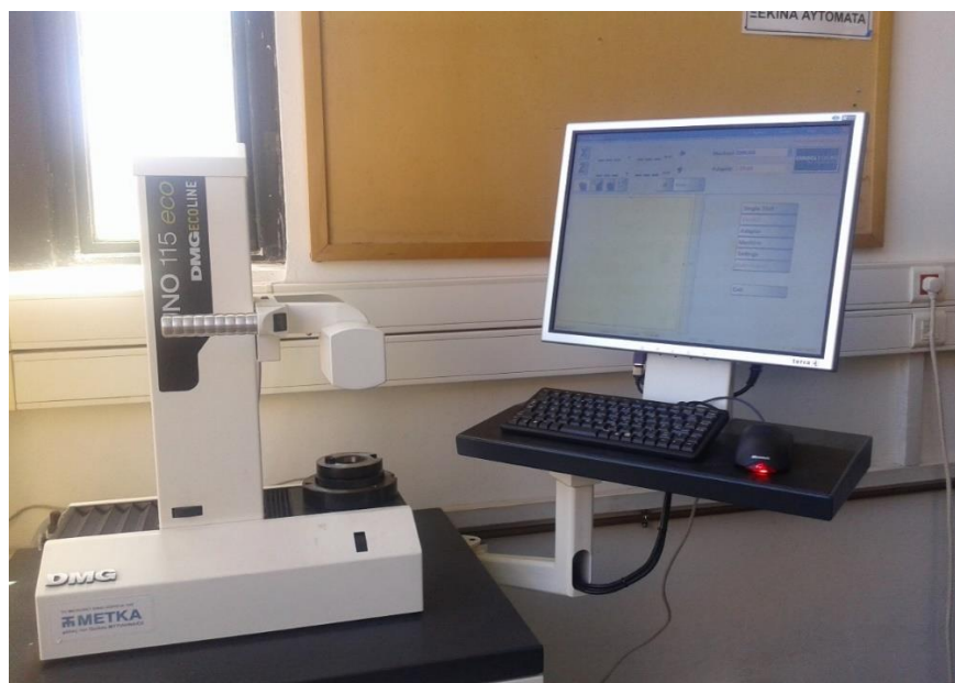
Σχήμα 3.3: Συσκευή προϋθμισης εργαλείων MICROSET Uno 115 eco
