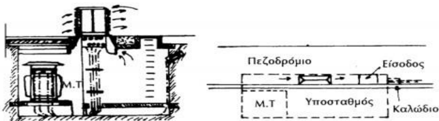
Σχήμα 1.9: Υπόγειος υποσταθμός διανομής [6]
