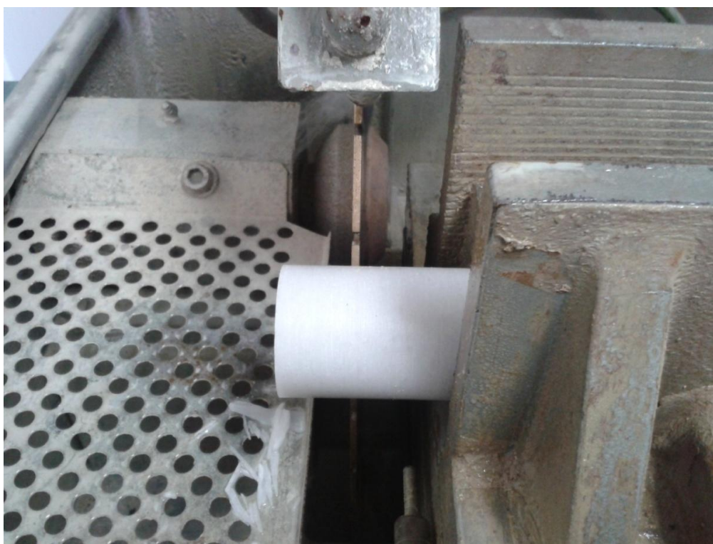
Σχήμα 4.10: Εργαστηριακό δισκοπρίνο με αδαμαντοτροχό κατά την διαδικασία της κοπής του κυλινδρικού δοκιμίου.
