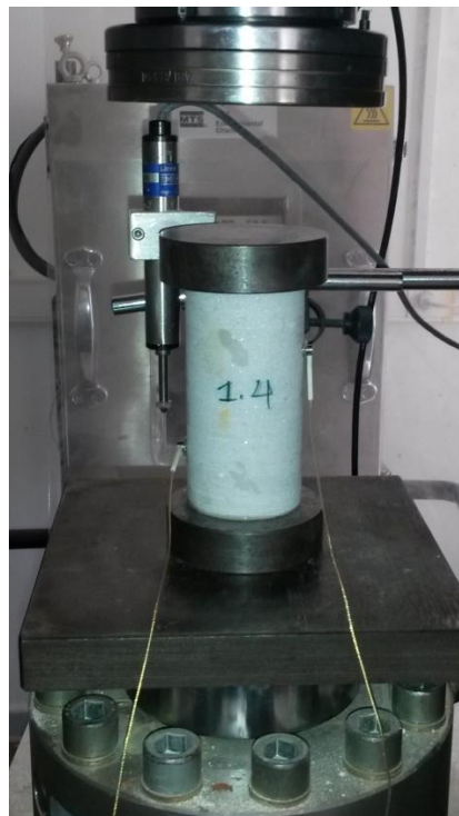
Σχήμα 2.2: Κυλινδρικό δοκίμιο για τη δοκιμή μονοαξονικής θλίψης
