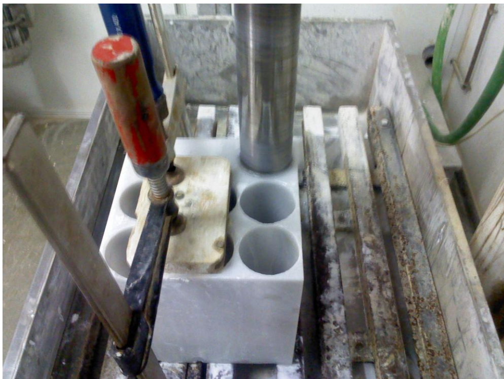
Σχήμα 4.8: Εργαστηριακός πυρηνολήπτης δοκιμίων κατά τη διαδικασία της διάτρησης του μαρμάρινου όγκου.
