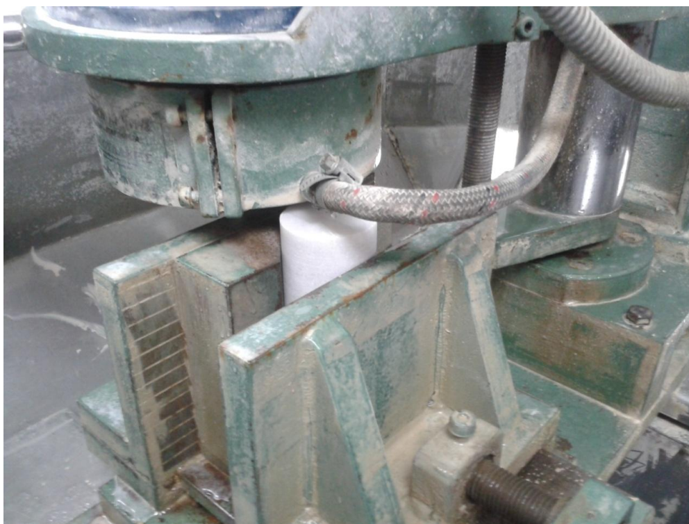
Σχήμα 4.9: Εργαστηριακός λειαντής δοκιμίων κατά τη διαδικασία της λείανσης.
