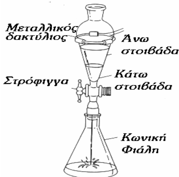
Εικόνα 2-1: Διάταξη εκχύλισης υγρού-υγρού μέσου (LLE). [17]
