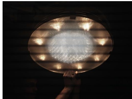
Εικόνα 38: Ο διαχυτής του συστήματος φωτισμού
