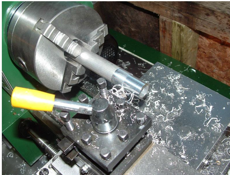
Σχήμα 2.1: Διάταξη τόρνευσης
