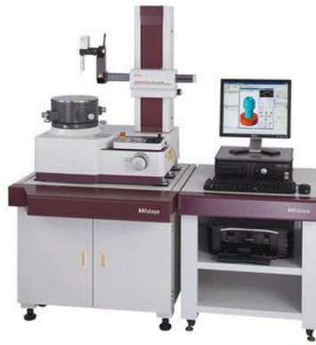
Σχήμα 2.17 Μηχανή μέτρησης της επιπεδότητας με ακίδα
