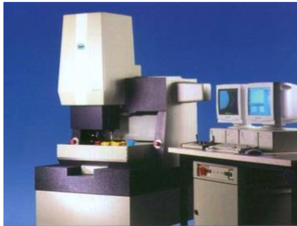
Σχήμα 2.18 Μηχανή μέτρησης της επιπεδότητας με probe
