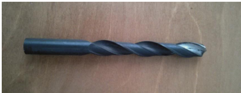
Σχήμα 3.6 Κοπτικό εργαλείο διάτρησης 14 mm
