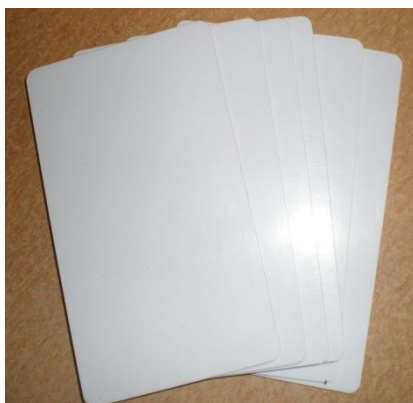
Εικόνα 7: Οι παθητικές ετικέτες RFID EM4100 που χρησιμοποιήθηκαν στην υλοποίηση
