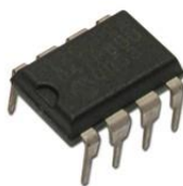
Εικόνα 4: Το ολοκληρωμένο DS1307 σε 8-DIP μορφή
