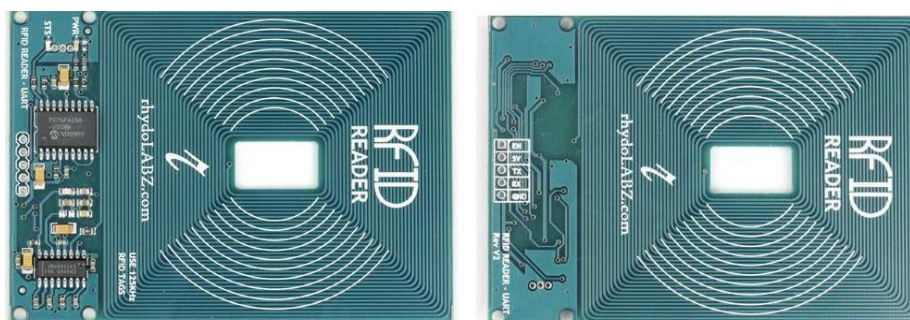
Εικόνα 1: Ο αναγνώστης RFID (125 KHz) Serial TTL της rhydoLABZ
