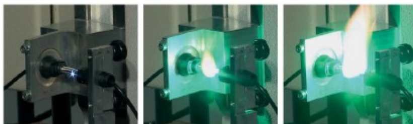
Εικόνα 3-12: Κίνδυνος δημιουργίας τόξου κατά την αποσύνδεση του αντιστροφέα από τη ΦΒ γεννήτρια.
