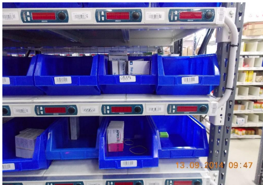
Εικόνα 2.23 Ράφι τύπου pick by light
