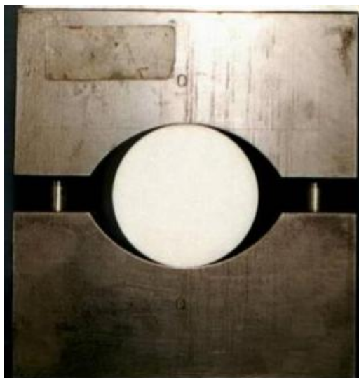
Σχήμα 1.2: Διάταξη δοκιμής Βραζιλιανού δίσκου
