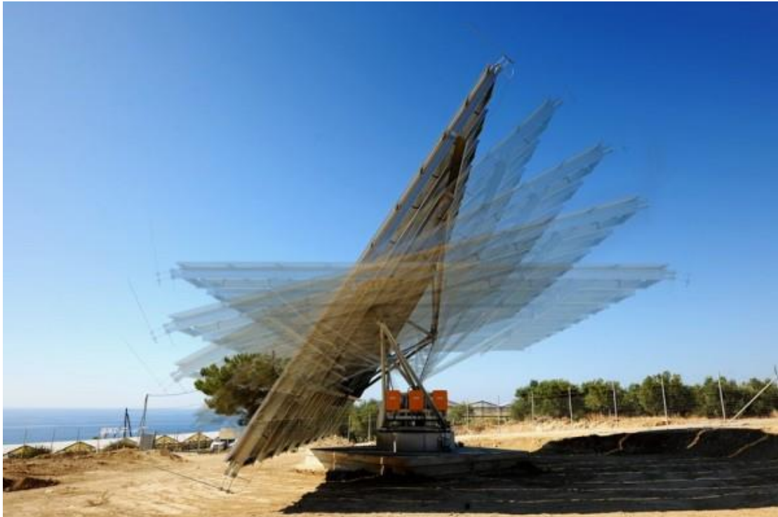
Εικόνα 29: Κινούμενα συστήματα στήριξης
