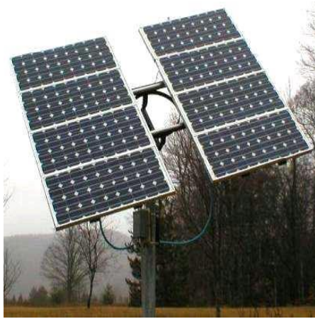
Εικόνα 21: Σύστημα παρακολούθησης της τροχιάς στον οριζόντιο άξονα
