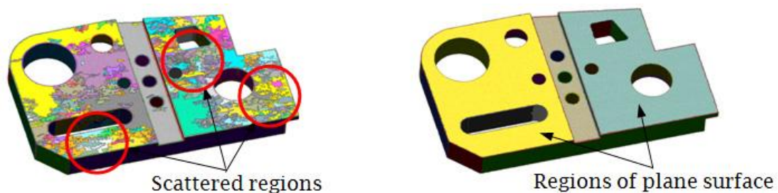
Εικόνα 15 Παράδειγμα πλεγματικής διακριτοποίησης (α) αντικείμενο διακριτοποιημένο σε πολλές μικρές Περιοχές εξαιτίας του κατωφλιού ευαισθησίας (β) Περιοχές καθορισμένες με χαμηλό κατώφλι ευαισθησίας
