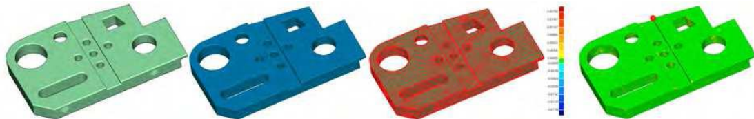
Εικόνα 19 Αποτελέσματα παραδείγματος του μπλοκ με τη χρήση Geomagic (α) μοντέλο σημείου θόλωσης (β) πολυγωνικό πλέγμα (γ) μοντέλο Nurb επιφάνειας (δ) ανάλυση απόκλισης
