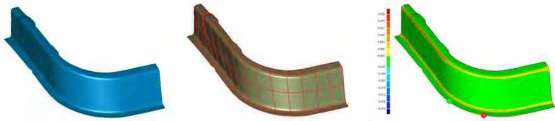
Εικόνα 21 Αποτελέσματα του μεταλλικού φύλλου με τη χρήση του Geomagic (α) πλέγμα πολυγώνων (β) το μοντέλο Nurb (γ) ανάλυση απόκλισης
