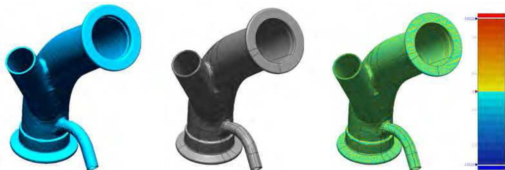
Εικόνα 25 Αποτελέσματα του παραδείγματος της σωλήνωσης δοκιμάζονται χρησιμοποιώντας το Rapidform (α) πολυγωνικό πλέγμα (β) NURB επιφανειακό μοντέλο (γ) ανάλυση απόκλισης
