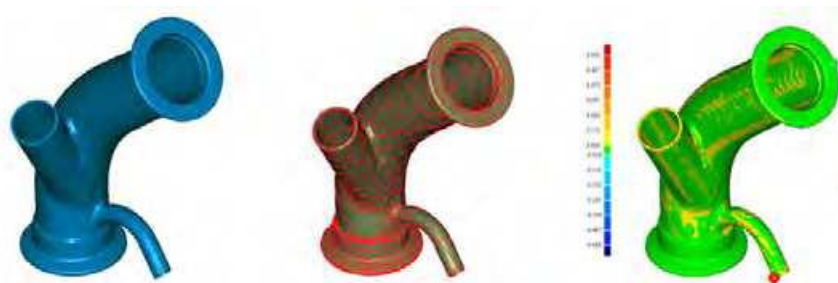
Εικόνα 20 Αποτελέσματα παραδείγματος σωλήνωσης δοκιμοζονται χρησιμοποιώντας το πρόγραμμα Geomagic (α) πλεγματικά πολυγωνα (β) μοντέλο Nurb (γ) ανάλυση απόκλισης
