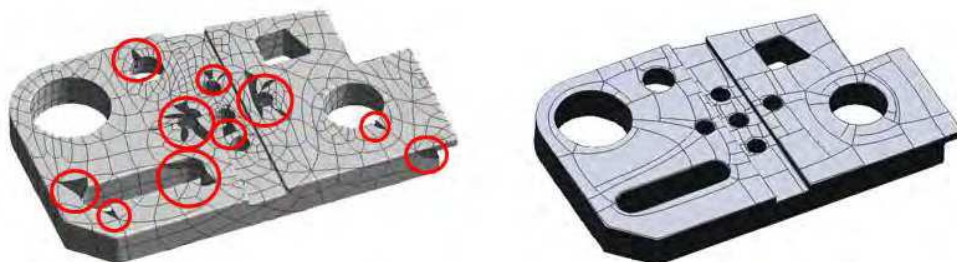
Εικόνα 22 Μοντέλα επιφανειών Nurb δημιουργούνται χρησιμοποιώντας δυο διαφορετικές επιλογές Rapidform (α) επιλογή ομοιόμορφου συστήματος (β) επιλογή συστήματος με βάση την ακολουθία χαρακτηριστικών
