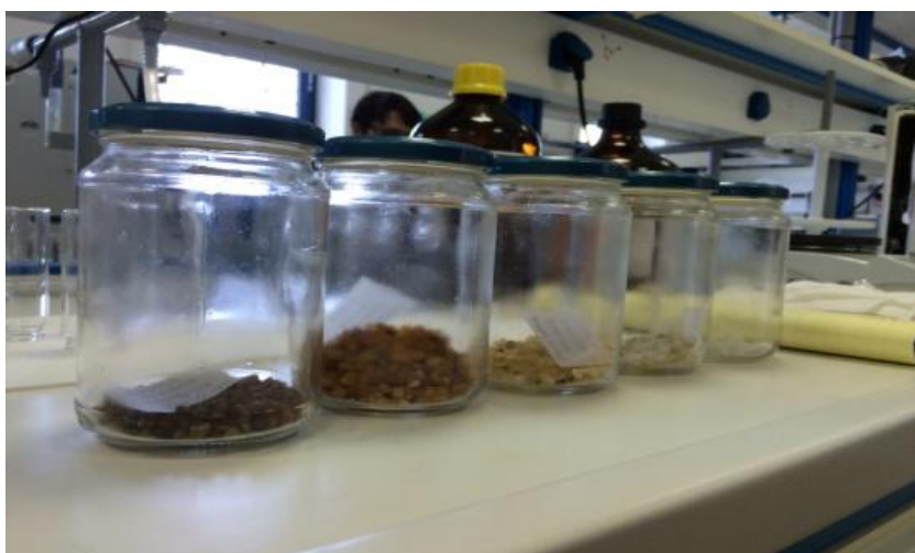
Φωτογραφία 2.3: Τυπικός διαχωρισμός των pellets με βάση το χρώμα (εκτιμώμενη γήρανση)
