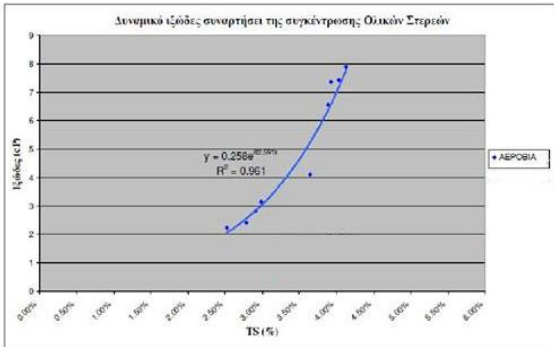
Σχήμα 5: Δυναμικό Ιξώδες συναρτήσει της συγκέντρωσης των στερεών.
