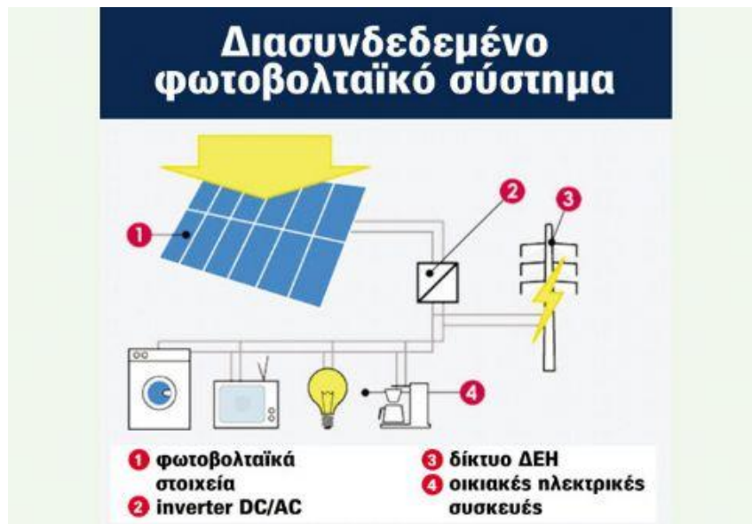
Εικόνα 3.4 Διασυνδεδεμένο φωτοβολταϊκό σύστημα.
