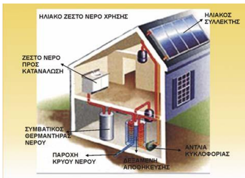
Εικόνα 1.8 Οικιακή εγκατάσταση για ζεστό νερό χρήσης.
