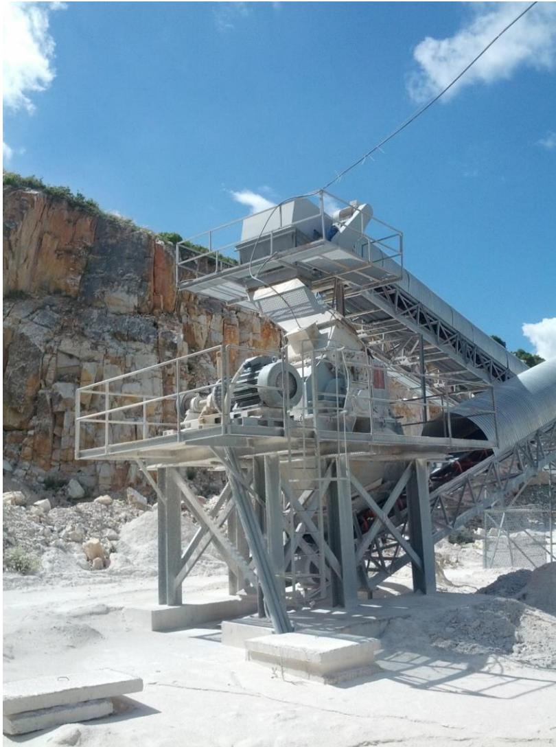
Σχήμα 3.10 Σπαστήρας ρότορας με σφυριά
