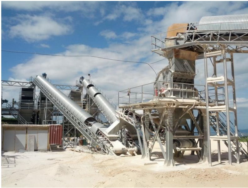
Σχήμα 3.9 Σπαστήρας-Ρότορας
