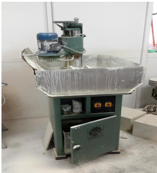
Σχήμα 4.3 Εργαστηριακός λειαντής δοκιμών
