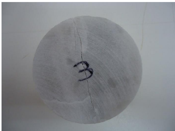
Σχήμα 4.12 Σπασμένο δοκίμιο με την μέθοδο Brazil
