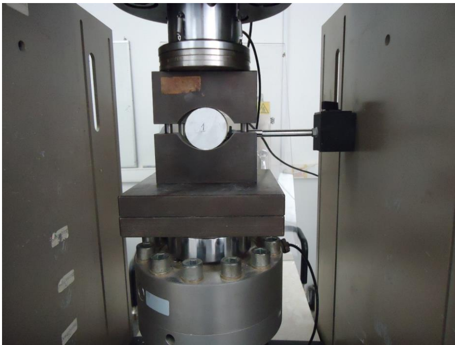
Σχήμα 4.11 Μέθοδος Brazil. Δοκίμιο πριν την επιβολή φορτίου.
