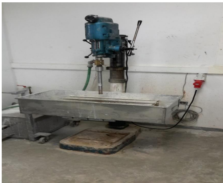
Σχήμα 4.1 Εργαστηριακός πυρηνολήπτης δοκιμίων
