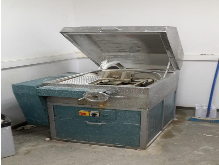
Σχήμα 4.2 Εργαστηριακό δισκοπρίονο δοκιμών
