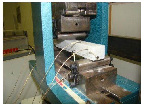
Σχήμα 5.7: Διάταξη αισθητήρων δοκίμιο 5
