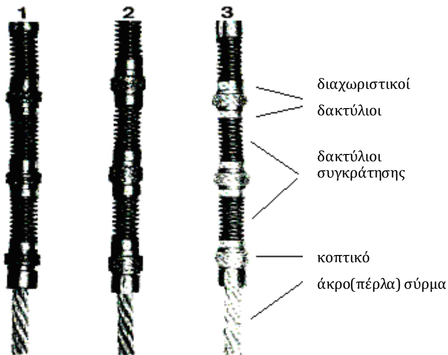
Σχ. 3.10. Σύρμα διαμαντέ για κοπή μαρμάρων και γρανιτών.
