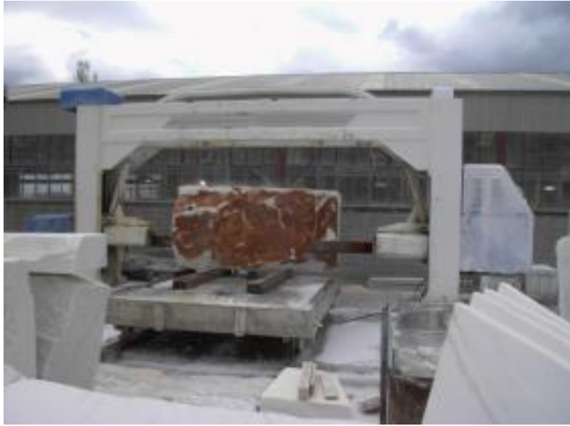
Σχ. 3.17. Ορθογωνισμός μαρμάρου στο εργοστάσιο με μονόλαμο
