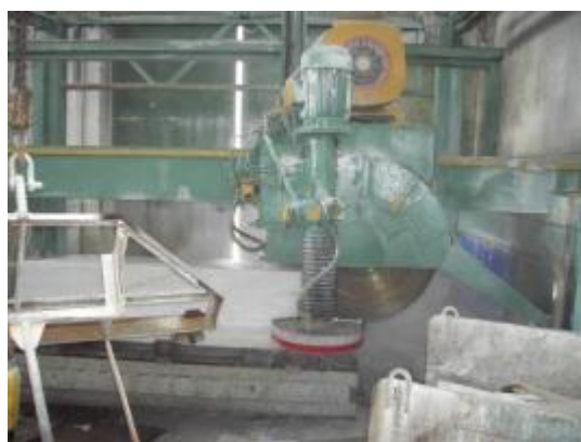
Σχ. 3.6. Διάταξη κοπής "οριζόντια – κάθετα"
