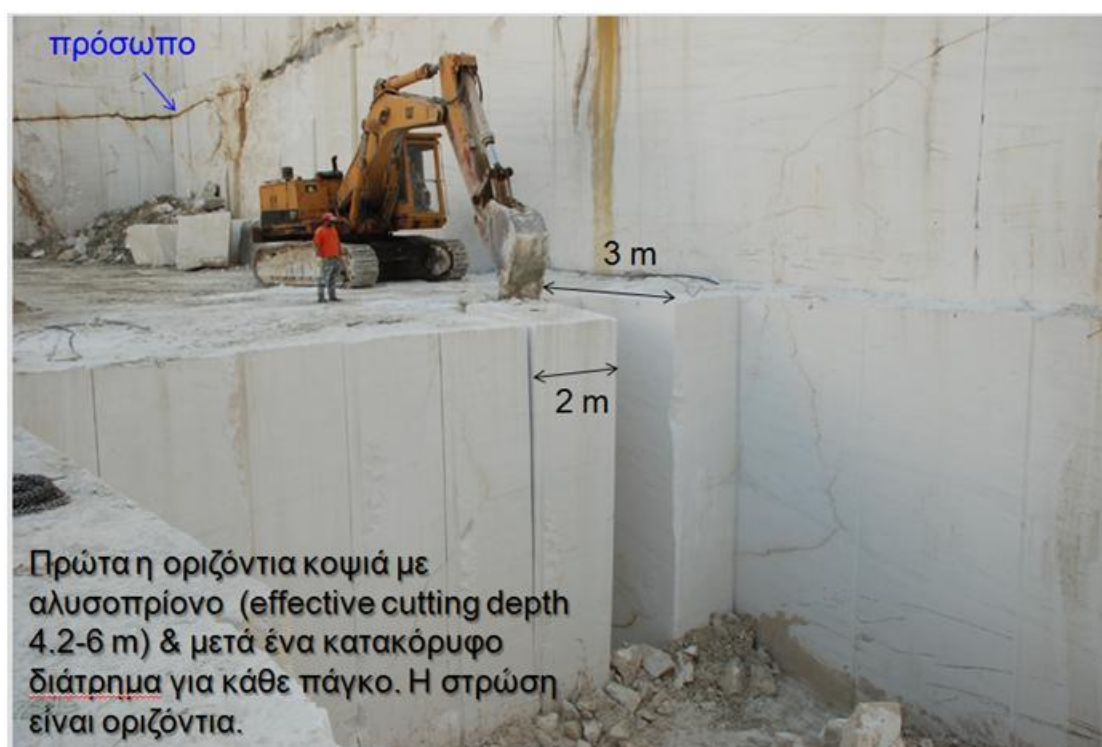
Σχ. 3.17. Μετακίνηση μπλοκ με χρήση τσάπας (Πηγή Εξαδάκτυλος 2007)
