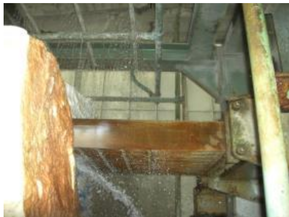
Σχ. 3.5. Τελάρο πολλαπλών λαμών σε λειτουργία
