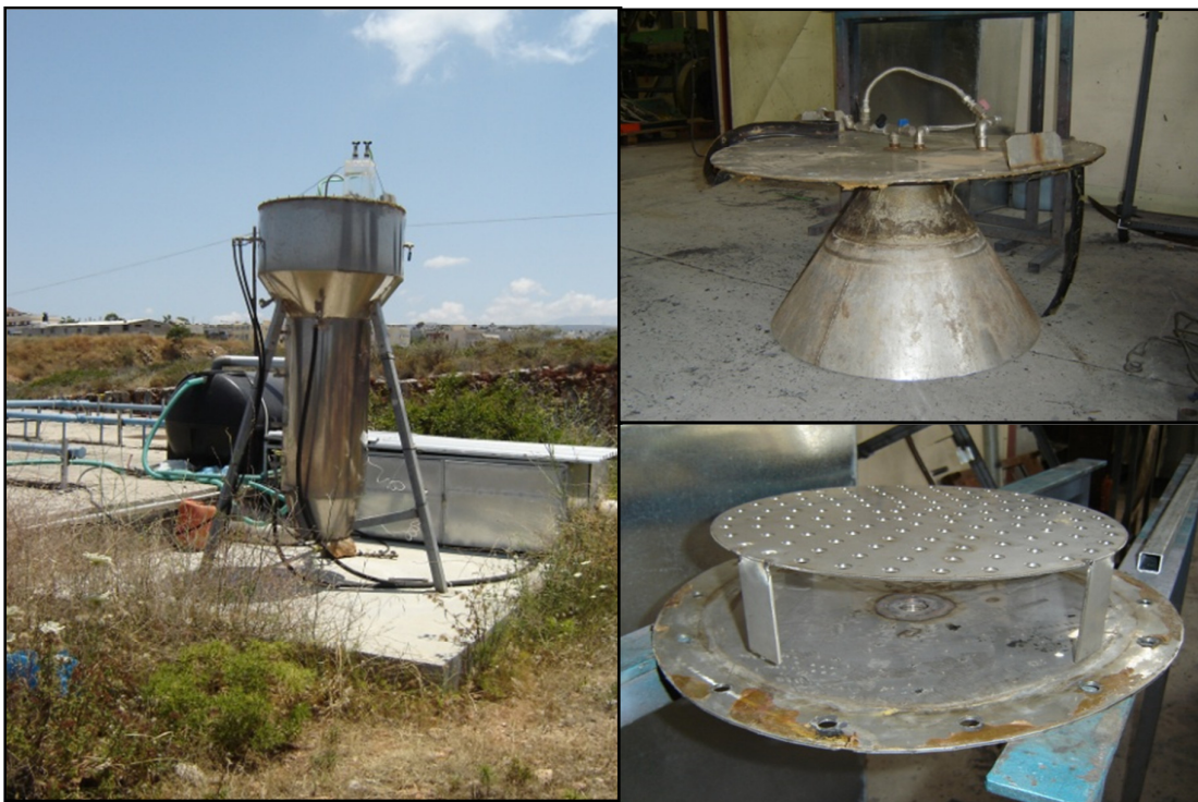
Εικόνα 3.14: Ο αντιδραστήρας UASB
