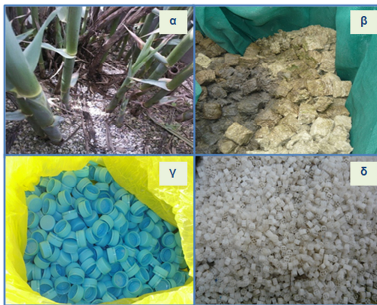
Εικόνα 3.12: Πληρωτικά υλικά α) τεχνητός υγροβιότοπος, β) κύβοι πετροβάμβακα, γ) καπάκια, δ) δακτύλιοι Kaldnes
